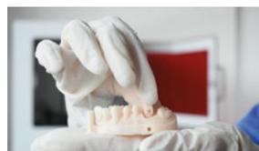
incrível de 65\_μm no plano XY horizontal e 50\_μm no plano Z vertical (até 10\_μm). O grau de detalhe e confiabilidade é surpreendente.
