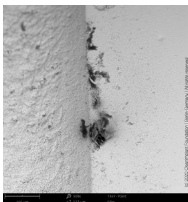
Fig. 9. Implante de titânio com uma grande contaminação (500X).
