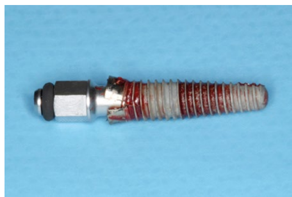
Figs. 10 e 11. Detalhe dos implantes explantados. Podemos ver como o colo de um deles se fraturou devido à baixa resistência da parede a esse nível.
