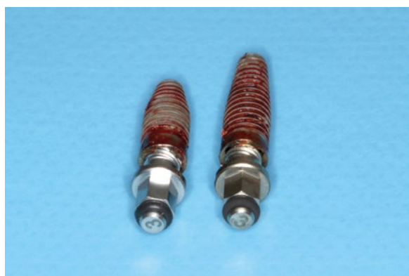
Figs. 10 e 11. Detalhe dos implantes explantados. Podemos ver como o colo de um deles se fraturou devido à baixa resistência da parede a esse nível.
